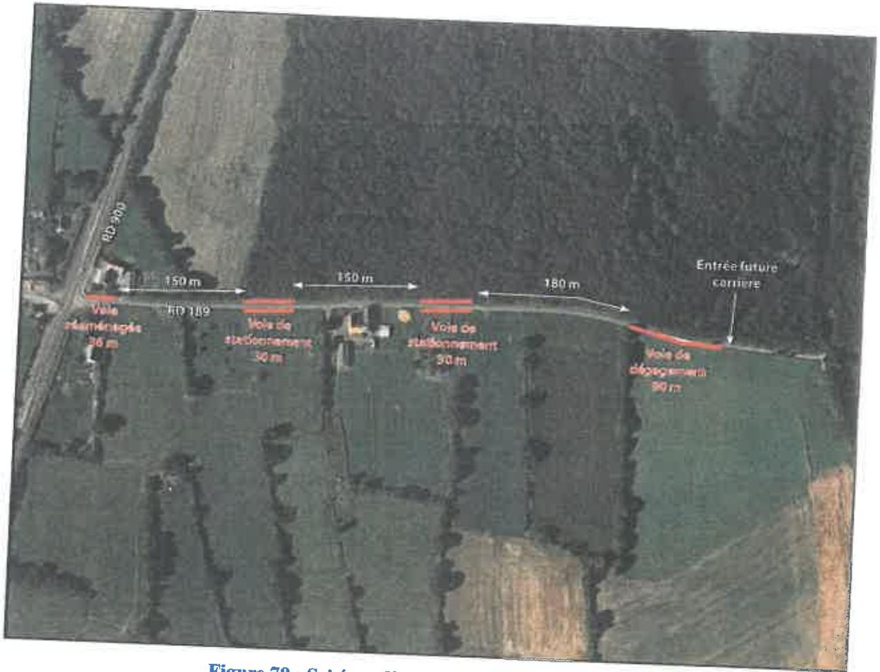
Figure 79 : Schéma d'aménagement de la RD 189
